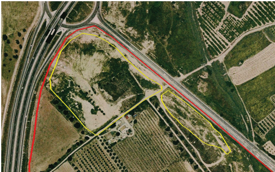
Figura 2.5.- Identificació de la zones amb reblerts superficials a l'any 2004 (Font: elaboració pròpia a partir de Google Earth Pro)
