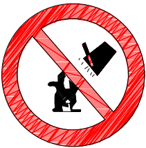
PROHIBIT APAGAR AMB AIGUA
