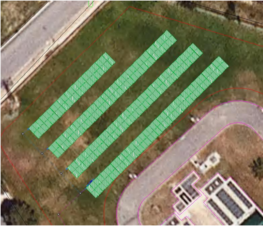
Figura 3 Implantació dels panells FV
