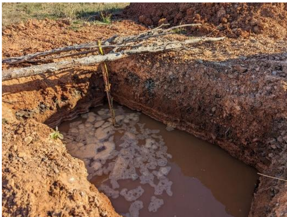
Figura 1. Ensayo de permeabilidad en zanja en Los Belones, Murcia-ES.
