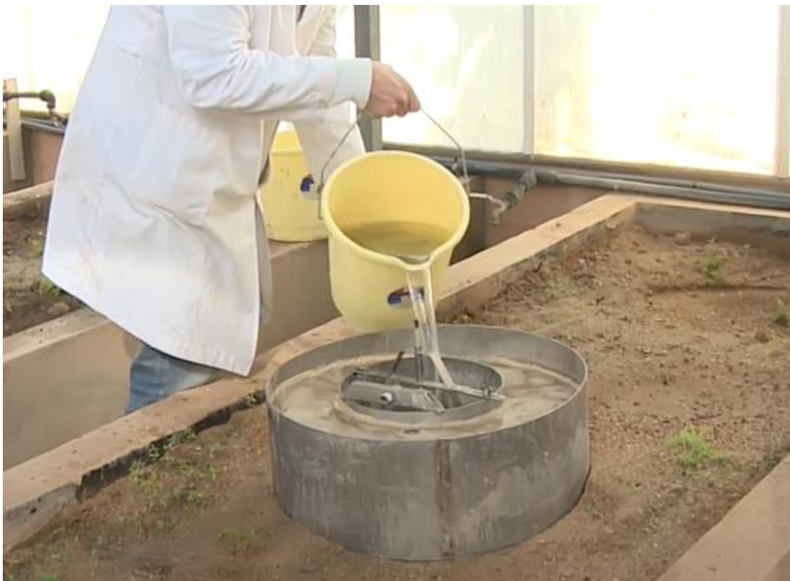
Figura 3. Ensayo de permeabilidad mediante un infiltrómetro de doble anillo. Fuente: Universitat Politècnica de València – Sara Ibáñez Asensio.
