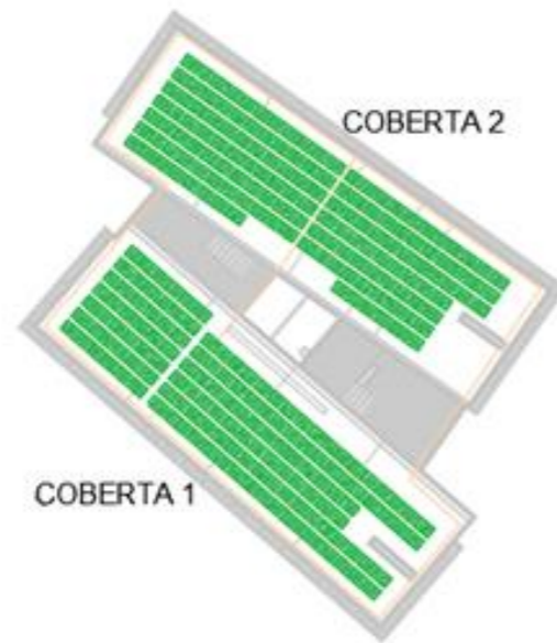
Figura 3 Implantació dels panells FV
