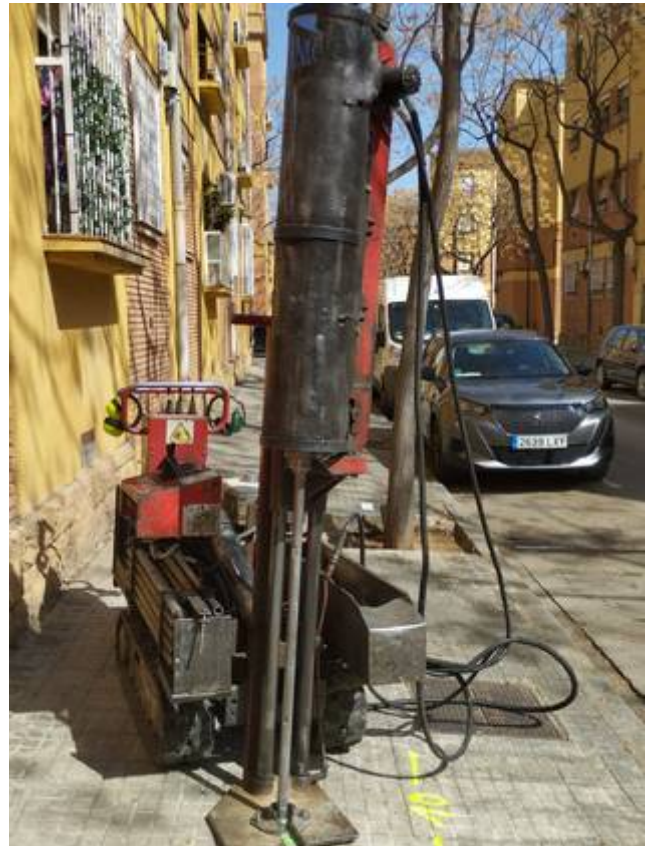
Vistes de quatre dels deu sondeigs realitzats a la parcel·la objecte d'estudi, P-5 i P-8 del tipus DPSH i, S-6 i S-7 del tipus Rotació helicoidal.
