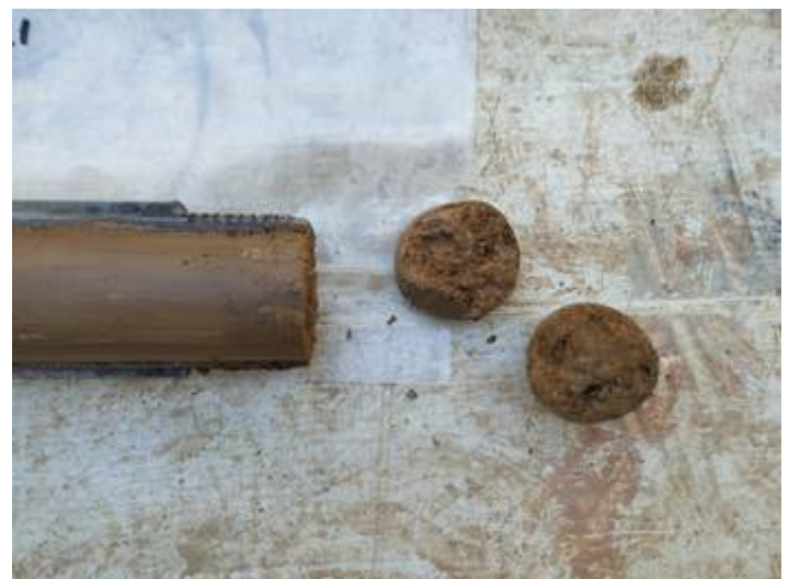
Vistes dels materials del subsòl extrets en tres assaigs SPT realitzats al llarg del sondeig S-6.
