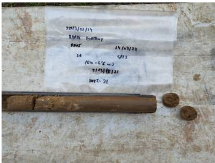
Vistes dels materials del subsòl extrets en tres assaigs SPT realitzats al llarg del sondeig S-6.
