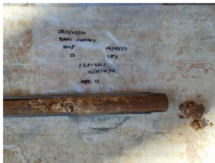
Vistes dels materials del subsòl extrets en tres assaigs SPT realitzats al llarg del sondeig S-3.
