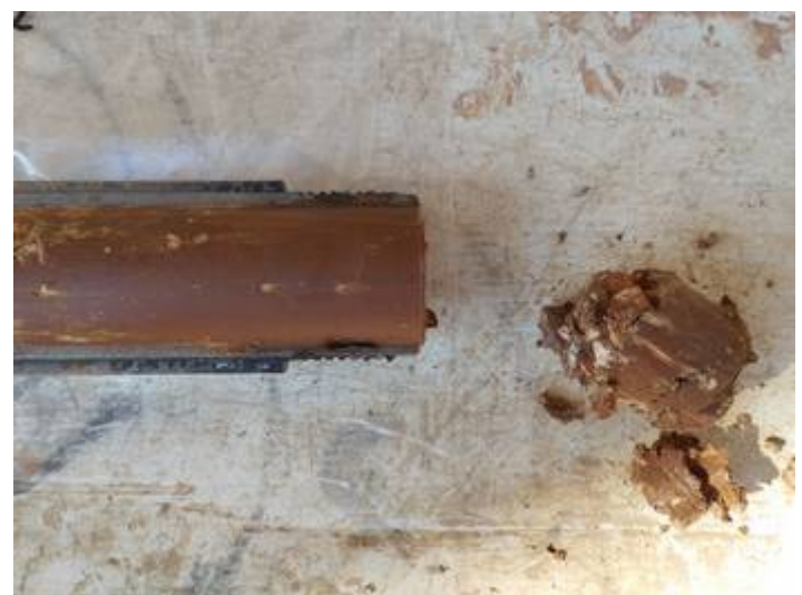
Vistes dels materials del subsòl extrets en tres assaigs SPT realitzats al llarg del sondeig S-3.
