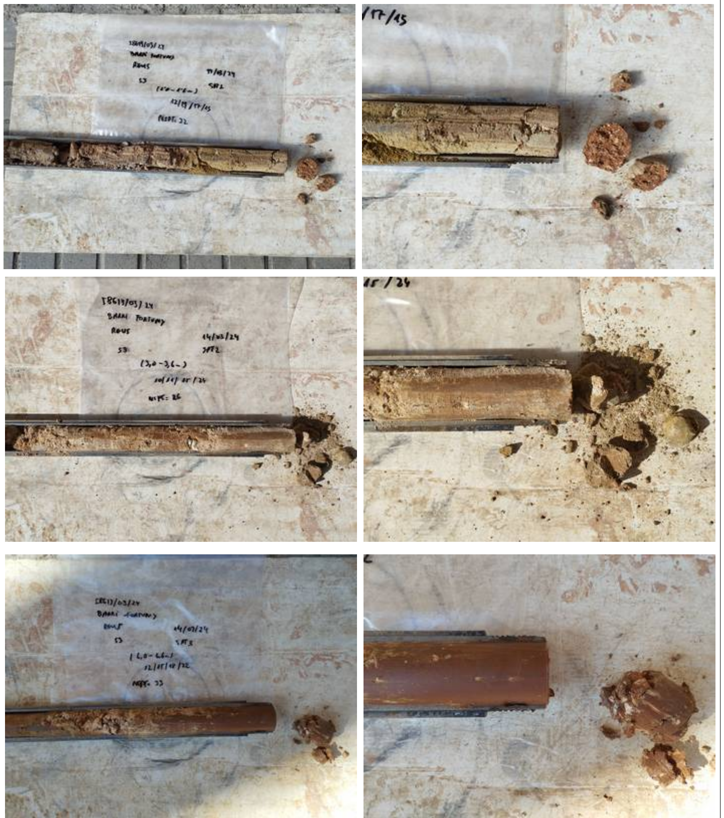
Vistes dels materials del subsòl extrets en tres assaigs SPT realitzats al llarg del sondeig S-3.
