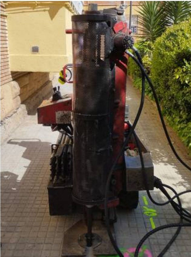
Vistes de dos dels deu sondeigs realitzats a la parcel·la objecte d'estudi, P-9 i P-10 del tipus DPSH.
