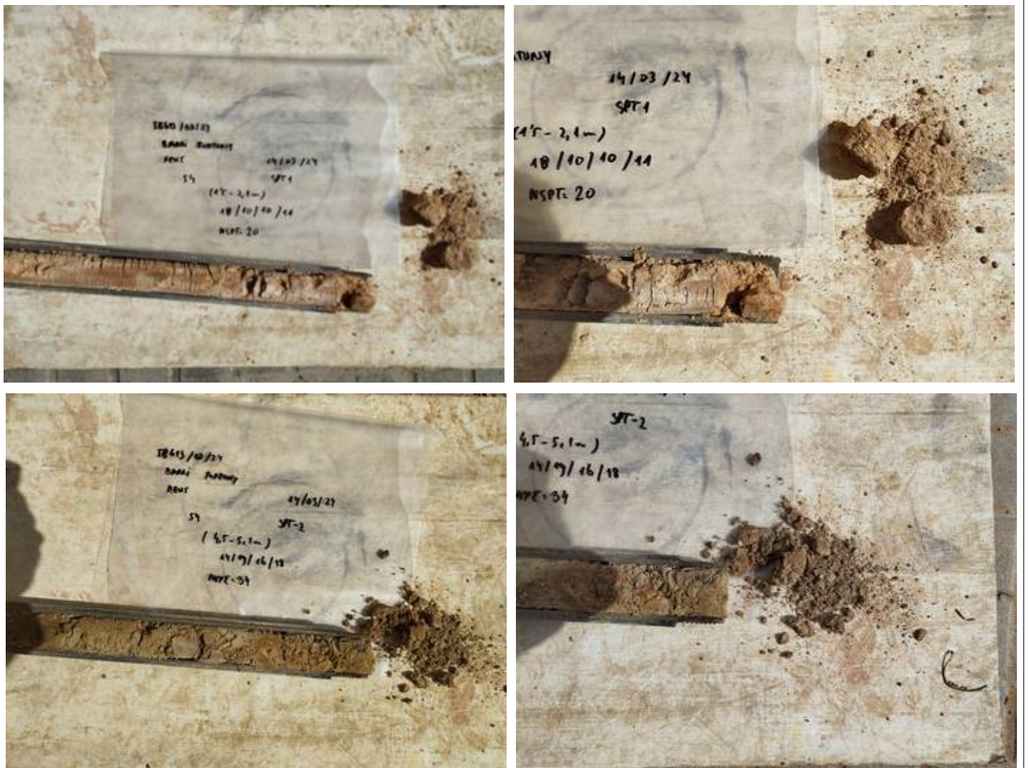
Vistes dels materials del subsòl extrets en dos assaigs SPT realitzats al llarg del sondeig S-4.
