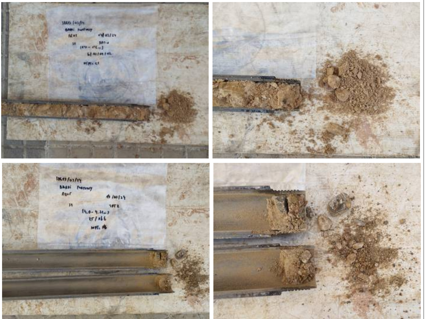
Vistes dels materials del subsòl extrets en dos assaigs SPT realitzats al llarg del sondeig S-1.
