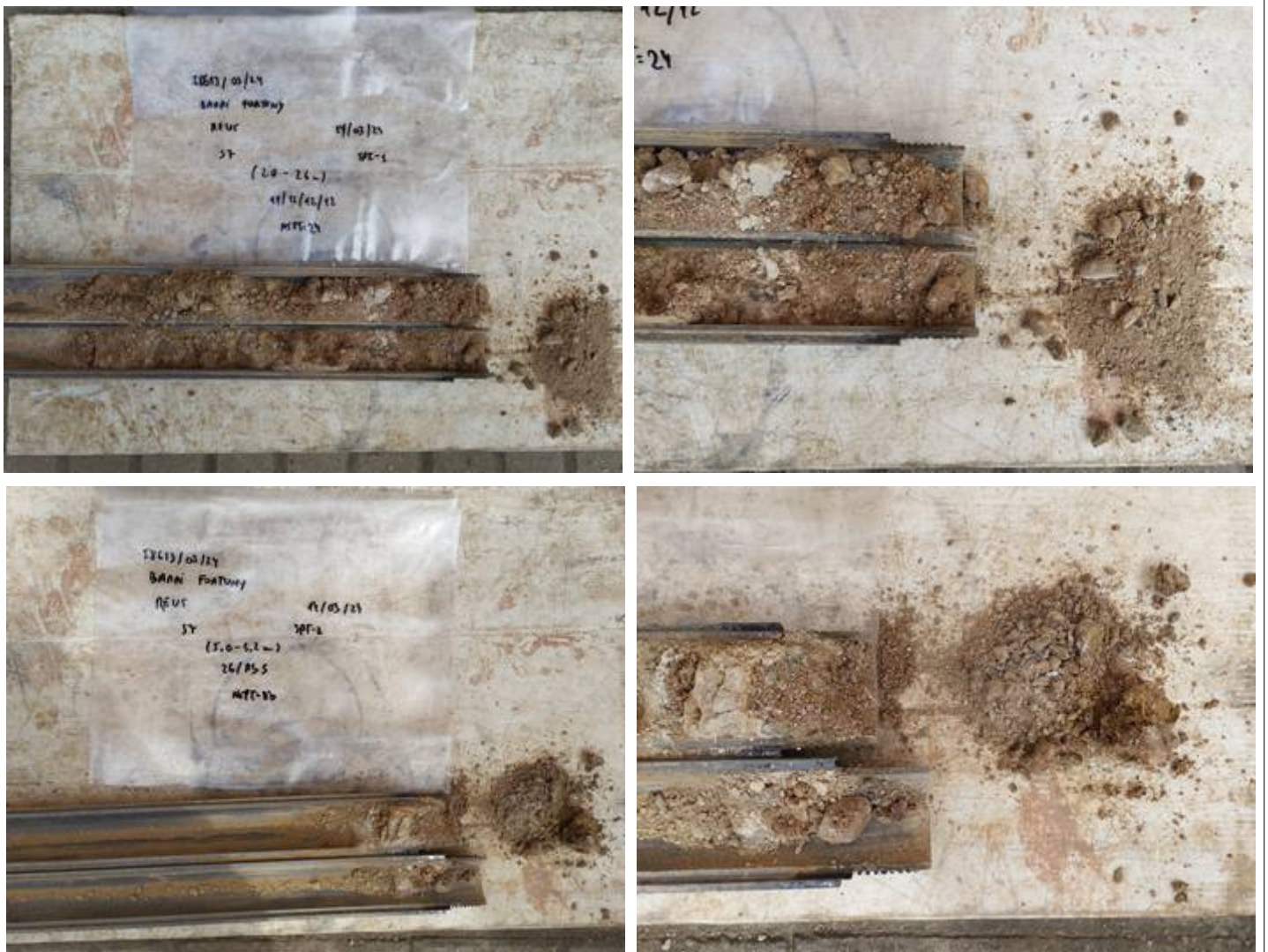
Vistes dels materials del subsòl extrets en dos assaigs SPT realitzats al llarg del sondeig S-7.
