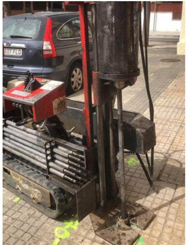
Vistes de dos dels deu sondeigs realitzats a la parcel·la objecte d'estudi, P-9 i P-10 del tipus DPSH.
