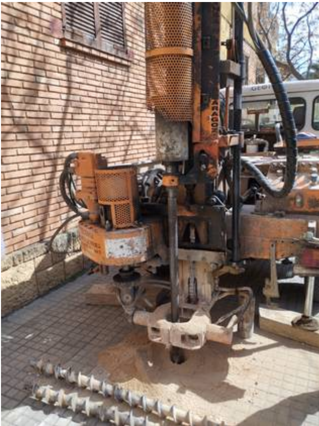
Vistes de quatre dels deu sondeigs realitzats a la parcel·la objecte d'estudi, P-5 i P-8 del tipus DPSH i, S-6 i S-7 del tipus Rotació helicoidal.
