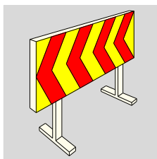
PLAFONS DIRECCIONALS PER OBRES
