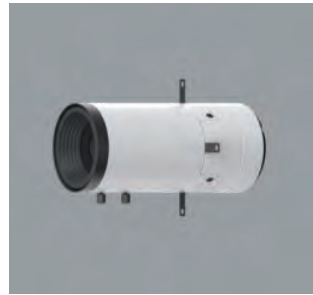
AC002260 Lens unit wide framing Aluminio/material sintético, lacado blanco, girable 360°. Sustituible sin herramientas. 2 lentes de proyección, ajustable sin escalonamiento. Ideal para distancias de proyección pequeñas. Regulador de contornos: acero inoxidable, negro. Diafragma de apertura. Peso 0,55kg
