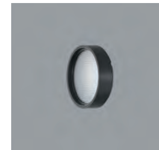
AC002071 Lens unit wide flood Material sintético, lacado negro, girable 360°. Sustituible sin herramientas. Lente Spherolit de polímero óptico. Peso 0,14kg
