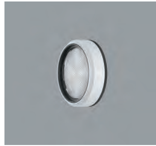
AC002130 Lens unit zoom spot Material sintético, blanco, girable 360°. Sustituible sin herramientas. Lente de enfoque antirreflectante de polímero óptico, ajustable sin escalonamiento. Peso 0,09kg
