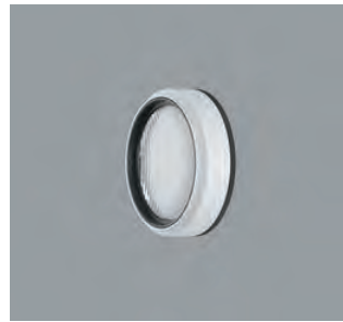
AC002132 Lens unit zoom oval Material sintético, blanco, girable 360°. Sustituible sin herramientas. Lente de enfoque antirreflectante de polímero óptico, ajustable sin escalonamiento. Peso 0,09kg
