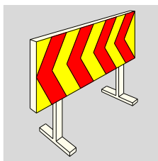
PLAFONS DIRECCIONALS PER OBRES
