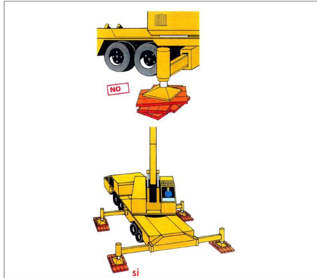
Col·locació estabilitzadors recolçaments
