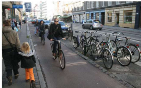
Figura 4.13. Exemple de carril bici situat a una cota diferent entre la vorera i la calçada (Copenhaguen)
