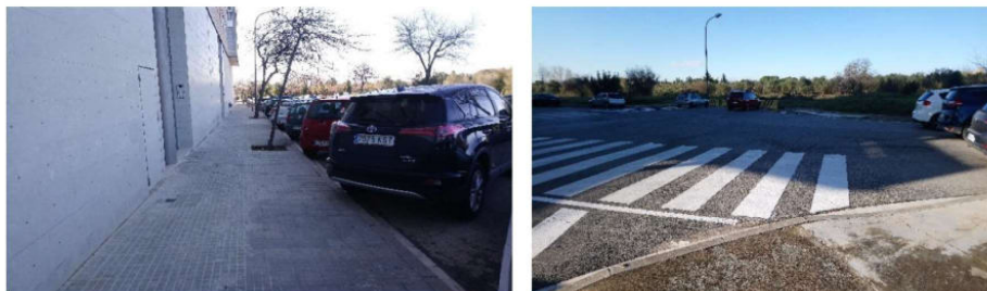
Figura 4.10. Carrer de la Ginesta, les voreres tenen una amplada útil de 1,6 m i cap dels guals de vianants és adaptat.
