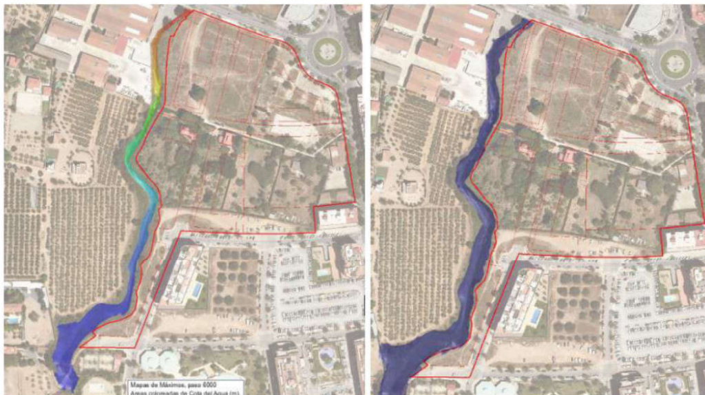
Fig. 19. Delimitació del DPH i de la zona inundable (T500) del tram del Barranc dels Capellans al seu pas per l'àmbit del Pla. Estudi d'inundabilitat. Adesti Enginyeria, 2021.
