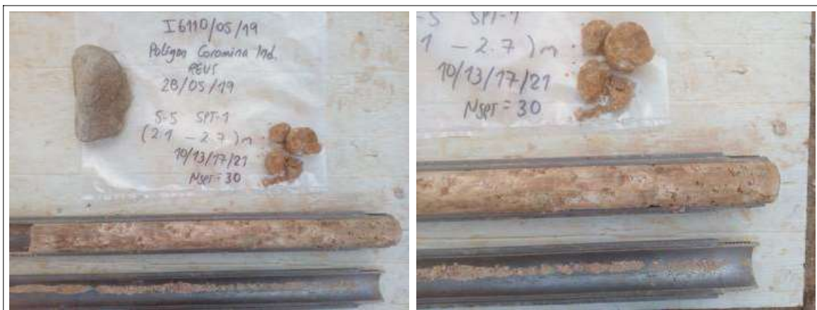
Vistes dels materials del subsòl extrets en un assaig SPT realitzat al llarg del sondeig S-5.
