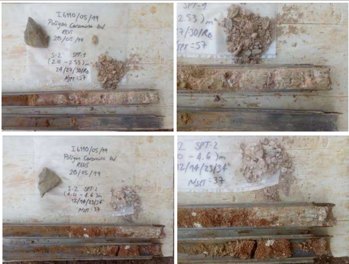
Vistes dels materials del subsòl extrets en dos assaigs SPT realitzats al llarg del sondeig S-2.
