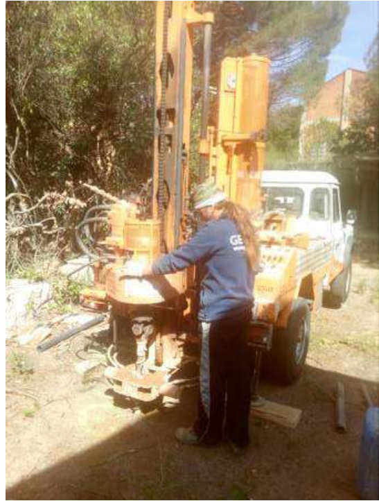
Vistes de dos dels cinc sondeigs realitzats a la zona objecte d'estudi, S-4 i S-5 del tipus Rotació helicoidal.
