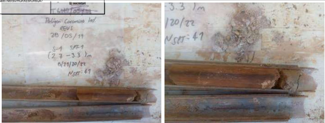
Vistes dels materials del subsòl extrets en un assaig SPT realitzat al llarg del sondeig S-1.
