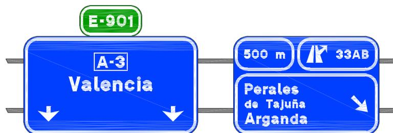
Si una salida estuviera situada inmediatamente después de un paso superior, solo podrá colocarse pórtico o banderola si su situación teórica (sin contar con el paso superior) distara de la estructura más de 150 m. En caso contrario, se desplazará el pórtico o banderola delante de la estructura, y si como consecuencia de ello la distancia entre estos y el pórtico o banderola inmediatamente anterior resultara menor de 150 m, se alejará el cartel anterior o se concentrarán todos los mensajes en él.
