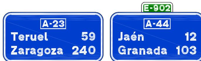
Se colocará un cartel de confirmación de ruta rebasado el último ramal de entrada de un enlace a 500 m de la “punta del cebreado”, siempre que su distancia al primer cartel de preseñalización de salida del siguiente enlace sea mayor de 500 m. Este cartel constará de cajetín del itinerario con su número, nombres primarios y secundarios, siempre con sus correspondientes distancias. Tendrán como máximo tres líneas de inscripciones además del cajetín de identificación de la carretera.
