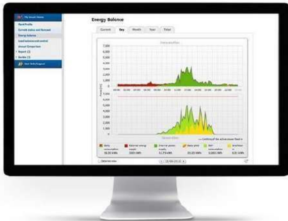
Figura 15: Software de monitorització de la planta fotovoltaica
