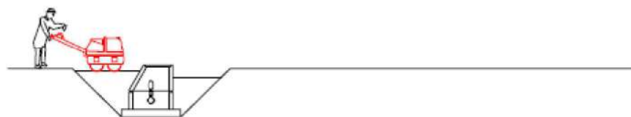
7. Compactació de terres al voltant del pou
