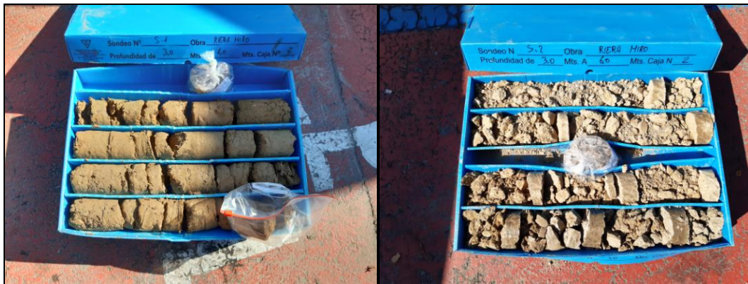
Imatge 4-2. Vista del nivell A al sondeig S-1 més llimós (esquerra) i al sondeig S-2, més sorrenc (dreta)
