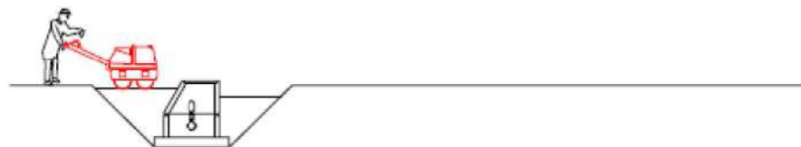
7. Compactació de terres al voltant del pou
