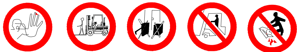
ALTO NO PASSAR PROHIBIT ACOMPANYANTS EN CARRETÓ PROHIBIT DIPOSITAR MATERIALS, MANTENIR LLIUERE EL PAS PROHIBIT EL PAS A CARRETONS PROHIBIT TREPITJAR TERRA NO SEGUR
