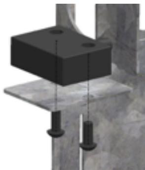
Figure 92 : Montage du capteur de fin de course
