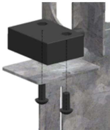
Figure 40 : Montage d'un détecteur de fin de course
