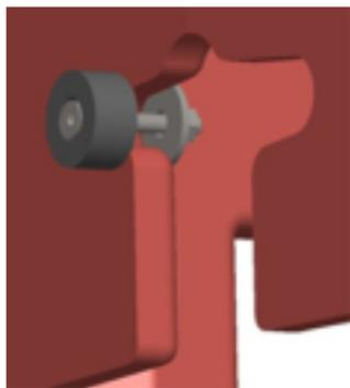
Figure 75 : Aimant installé
