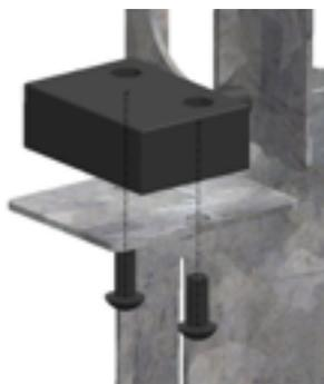
Figure 84 : Montage du capteur de fin de course avec des rivets en plastiques
